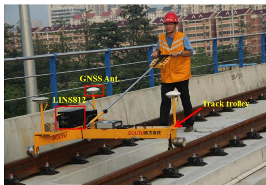
图 GNSS/INS 铁轨形变测量现场作业图
